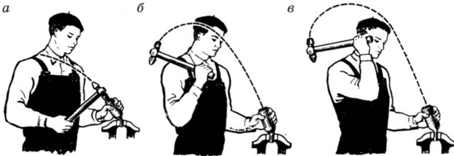
Рис. 4.10. Виды ударов при рубке: а — кистевой; б — локтевой; в — плечевой
